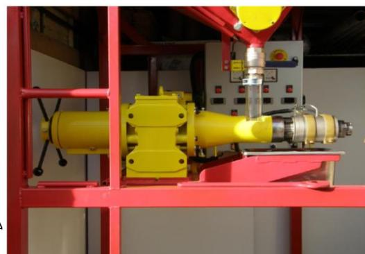
(pression + température), qui permet de réduire fortement le contenu des graines de soja en facteurs anti-trypsiques. Elle facilite également le pressage ultérieur de l'huile, afin d'obtenir un tourteau déshuilé, plus adapté aux besoins nutritionnels des animaux d'élevage.
